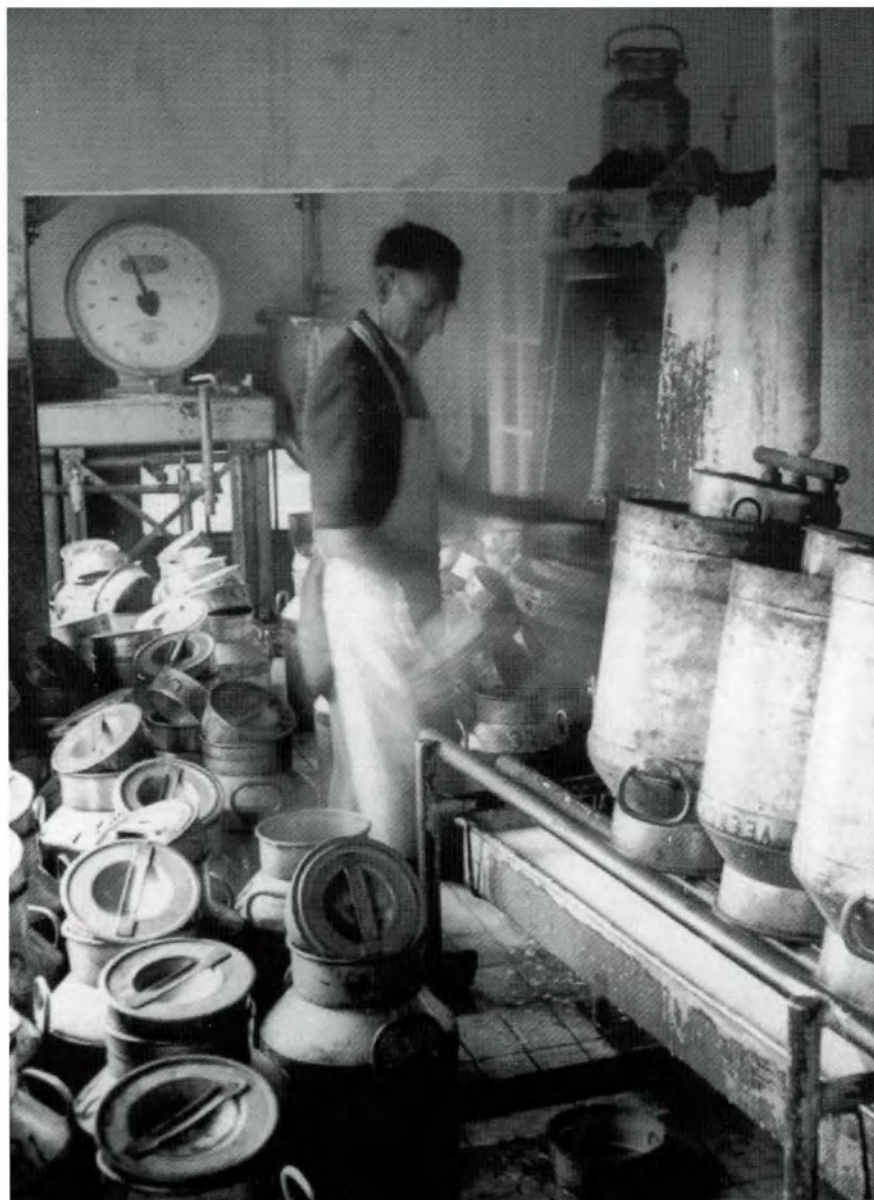
Bussenreiniger: Cees Beijers zorgt er voor dat de veehouders schone- en steriele bussen terugkrijgen door middel van soda en stoom.
